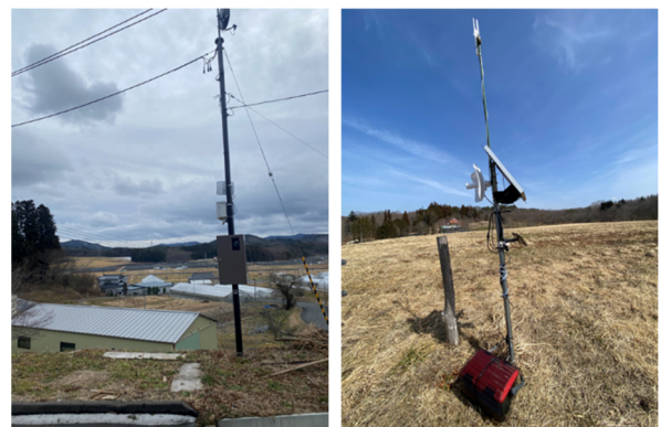
Fig.3 パラボラ WiFi アンテナによる長距離通信
